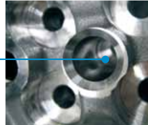
PKD Stufenreibahle Injektionsbohrung reiben (schlichten)
