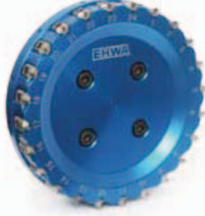
PKD Kassettenfräser Abgasseite planfräsen (schuppen und schlichten)
